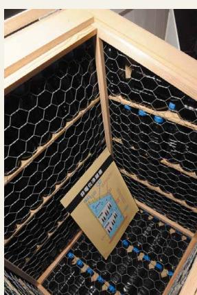
モンゴルの遊牧民のために製作した非電化冷蔵庫。製作費を安くするため、水を充填したペットボトルを使用。赤外線放射率を高めるため、内部は黒く塗られている。
