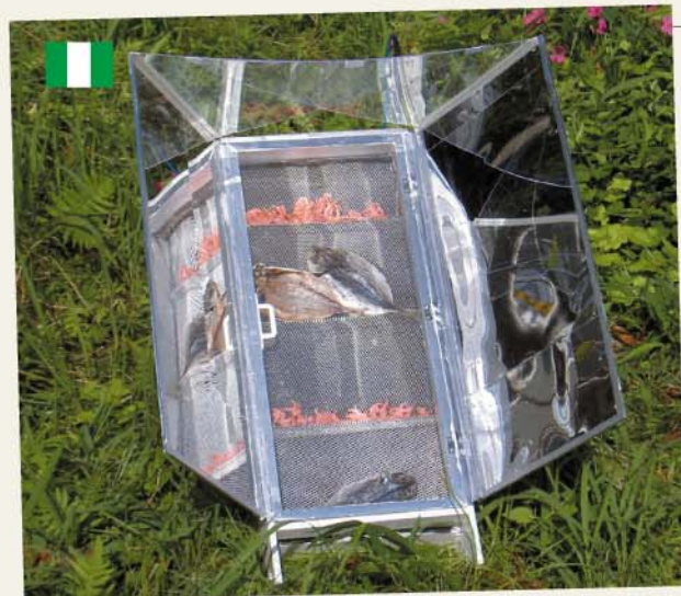
ナイジェリアモデルの干物製造装置。太陽光を集めて魚やエビを干物にする。
